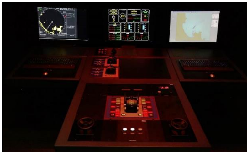
Figura 341. Consoles equipados com instrumentos reais de um navio e monitores de radar, informações da navegação e carta náutica eletrônica respectivamente.
