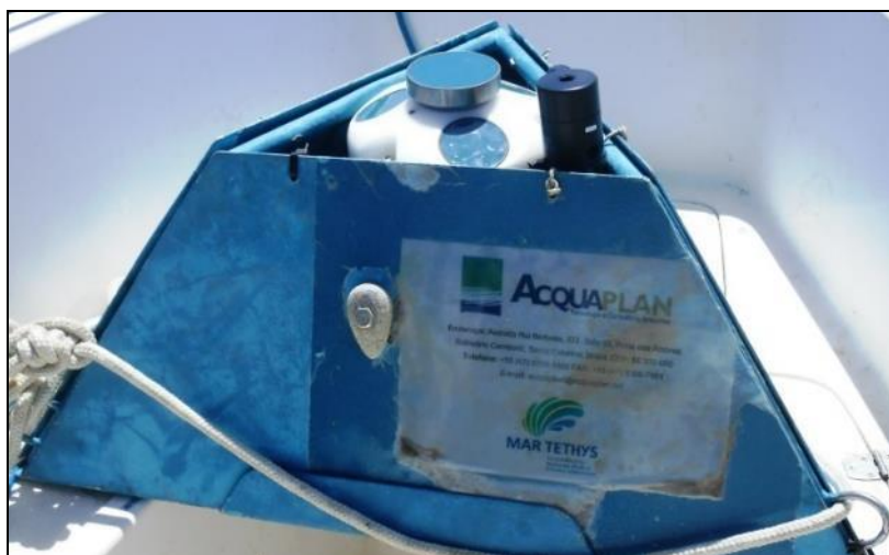
Figura 330. Equipamento AWAC® utilizado no fundeio já fixado em estrutura piramidal.
