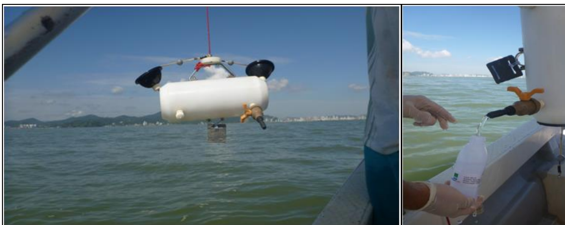
Figura 301. Garrafa usada para coleta de água e armazenamento da amostra em frasco identificado (garrafa amostradora do tipo van Dorn ).
