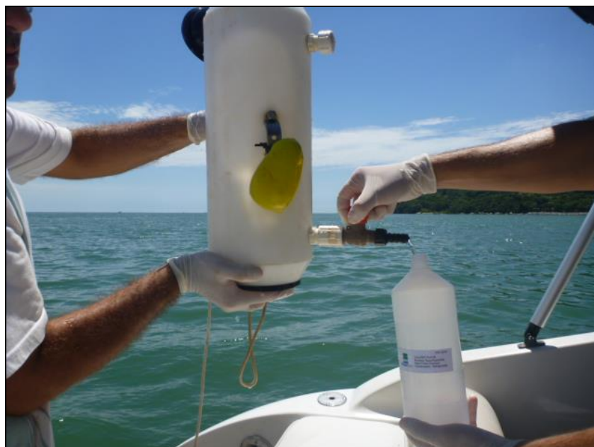
Figura 280. Amostra de água coletada com garrafa amostradora tipo van Dorn sendo acondicionada em frasco de plástico.
