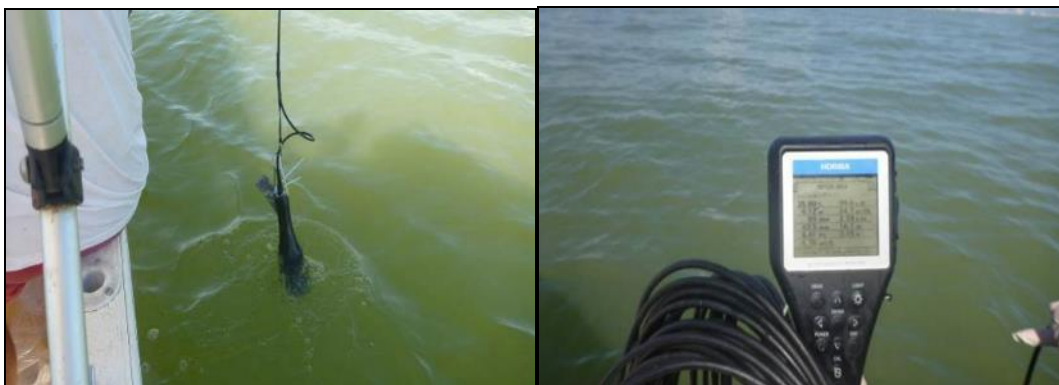
Figura 300. Medição dos parâmetros físico-químicos in situ .
